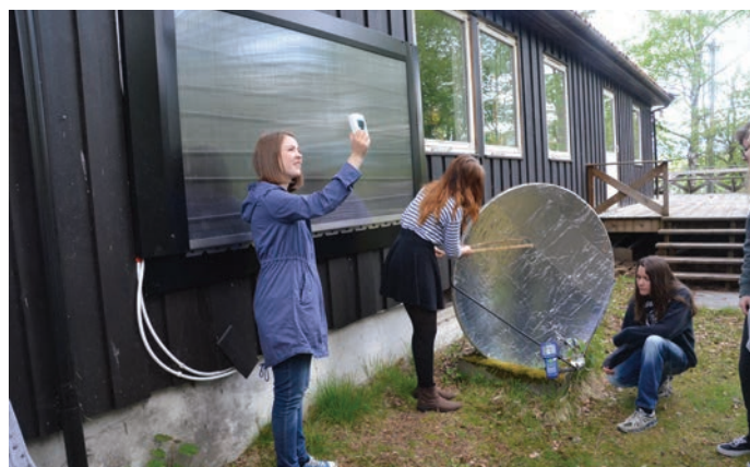
Elevar skal berekne verknadsgrad av solfangar og solomn. Foto: Trond Herfindal
