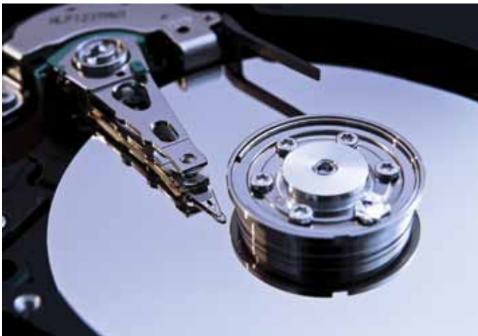
Magnetiske lesehoder basert på nanoteknologi ble anvendt i kommersielle lesehoder fra 1997. © Shutterstock
