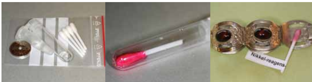
Utstyr som passer til påvisning av nikkellioner.
