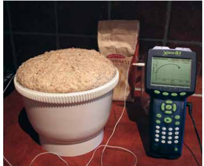
Figur 8: Ein ferdig heva brøddeig der deigtemperaturen har blitt logga i hevingssperioden. Etter at temperatursensoren var nappa ut, vart brøda forma til og steikte.
