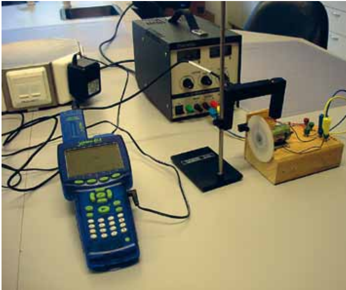
Figur 7: Måling av turtal på ein elektromotor. Lysporten er den store svarte "kloa" som er festa i stativet. Den eine armen sender ut lys inn mot pappskiva, den andre armen har ein lysdetektor som fangar opp lysblinka som kjem gjennom holet i pappskiva. Den store "kassa" med hank bak er ei spenningskilde som kan gje varierende likespenning. Eit batteri og ein liten dreiemotstand er like bra.
