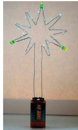
Stjerne i ståltråd med 3 lysdioder for 9 volts batteri og batteriklips.
