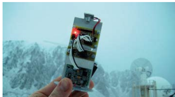
CanSat: Ferdig montert byggesett med sensorkort, hovedkort og sender
