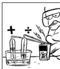
Gjenta slik at du får 2 stk, fyll petriskåla 3/4 full, koble til batteriet og observer!
