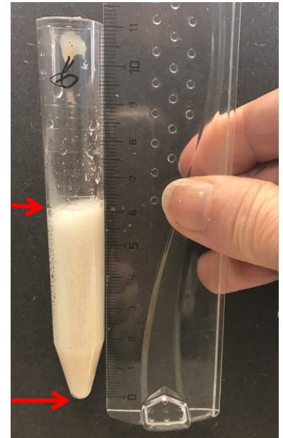
Figur 1: Når H_2O_2 blir blanda med gjær, blir det danna skum. Figuren viser korleis skumhøgda blir målt.
