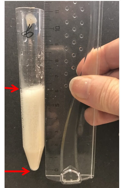
Figur 1: Når H_2O_2 blandes med gjær, dannes det skum. Figuren viser hvordan skumhøyden måles.
