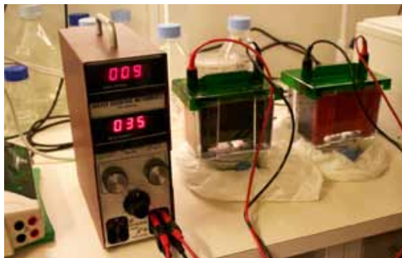
Western blottingen foregår over natten på et kjølerom som holder cirka 4°C.
